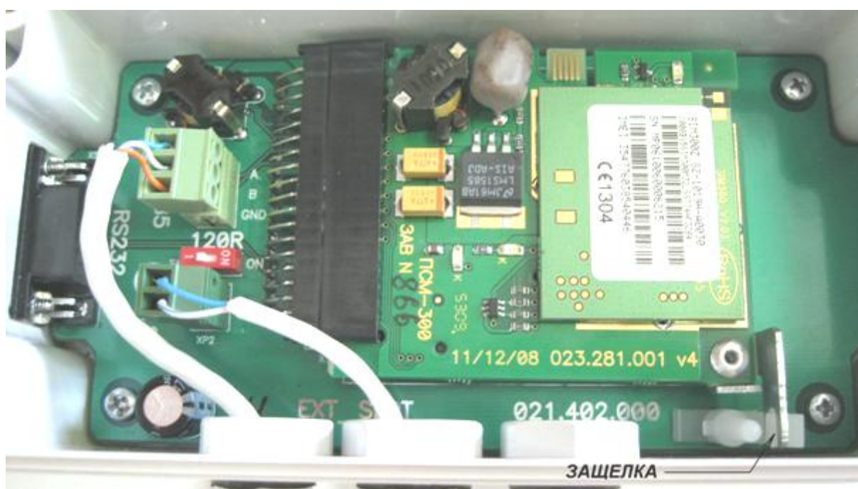
Рисунок 17.9. Фиксация ПР теплосчетчика МКТС в УППР.
