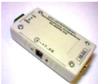
Рис. 6.1 Внешний вид преобразователя интерфейса RS-485/RS-232
