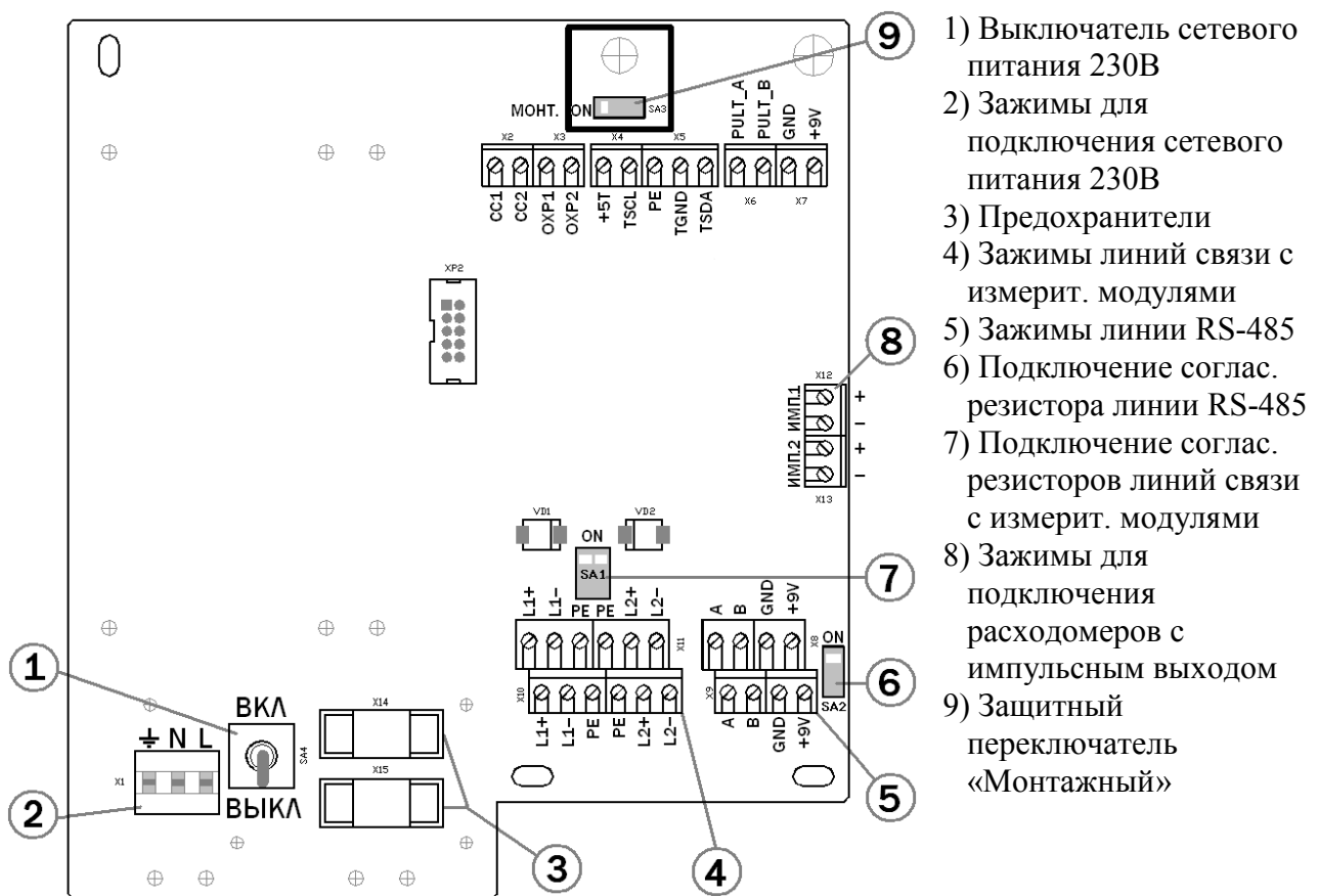
Рис Г-2. Расположение элементов на плате подключений МКТС
