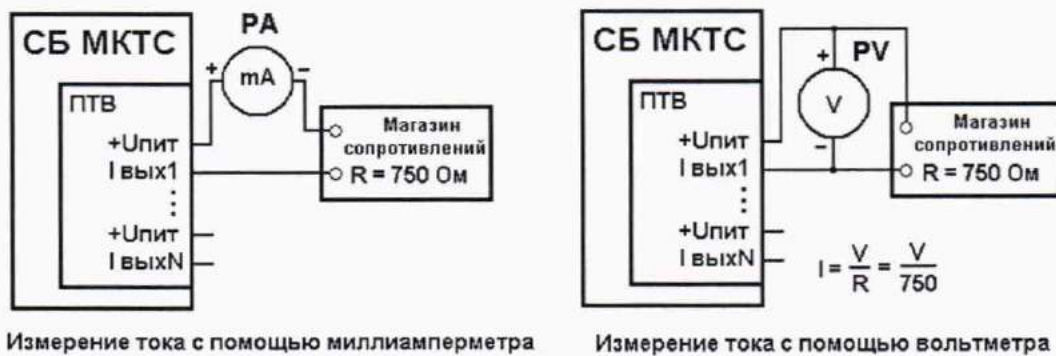
Рис. А4. Электрическая схема подключения приборов при проверке выходов постоянного тока 4-20 мА.
